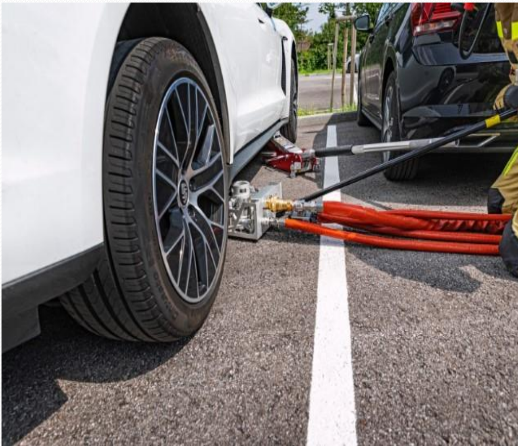
System gaszenia pożarów aut elektrycznych Rosenbauera /Informacja prasowa
