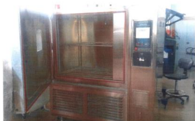
Rys. 52. Komora środowiskowa wykorzystana w teście odporności lakieru na zmienną temperaturę i zasolenie
