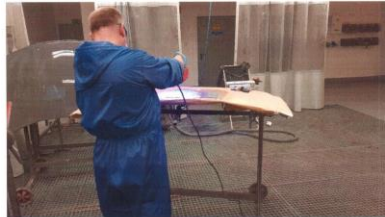
Rys. 8. Proces utwardzania promieniami UV próbek z nałożonym podkładem
